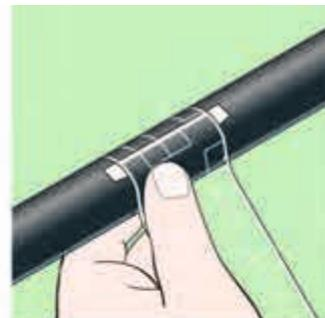
**Мерная лента Hawke для выбора уплотнительных модулей для кабелей и труб**
