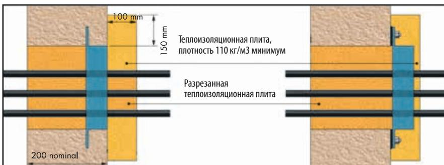
4. При определенных условиях может потребоваться ограничить среднее нагревание выше температуры окружающей среды на закрытой поверхности противопожарной стены или пола. Поскольку металл кабеля обладает хорошей теплопроводностью, рекомендуются следующие методы установки для обеспечения соответствия на период до 360 минут. (см. рис. 3 и 4).
