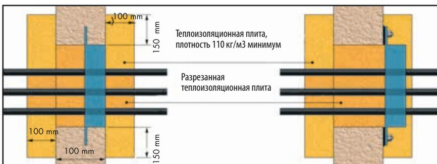
3. При периодах, превышающих 120 мин., может потребоваться монтаж рам с двух сторон стены или изоляция, как показано на рисунке. (Последнюю техническую информацию можно узнать в компании Hawke).
